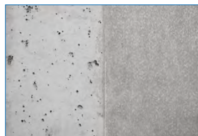
Links ohne Zemdrain®, rechts mit Zemdrain®.
