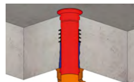
Einbausituation mit KRASO® Bodendurchführung Typ BDF
