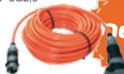
Nach DIN VDE 0298-4 dürfen Verlängerungskabel mit Leistungstyp H07RN-F 5G2,5 mm<sup>2</sup> mit maximal 23 A und H07RN-F 5G4 mm<sup>2</sup> mit maximal 30 A belastet werden.
