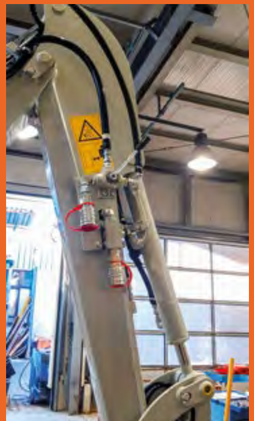
Konstruktion: Greiferumschaltung am Ausleger (Bild rechts)
