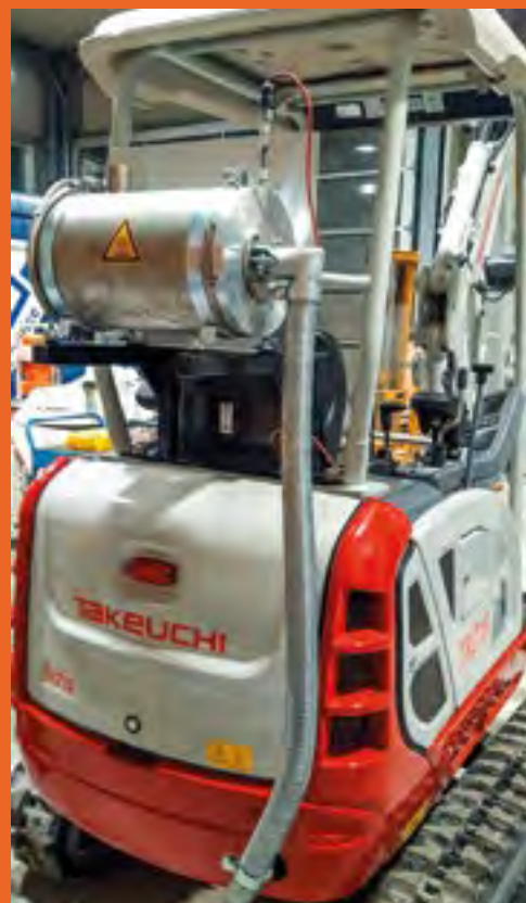
Sonderumbau: Kompaktbagger TB290 mit High-Flow-Hydraulik und Fernsteuerung
