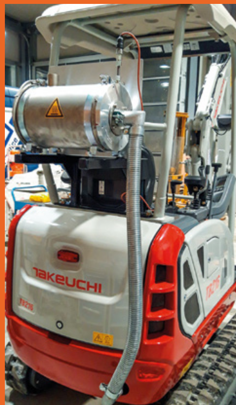
Sonderumbau: Kompaktbagger TB290 mit High-Flow-Hydraulik und Fernsteuerung
