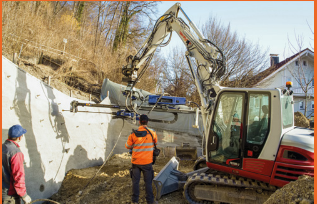
Sonderumbau: Kompaktbagger TB290 mit High-Flow-Hydraulik und Fernsteuerung
